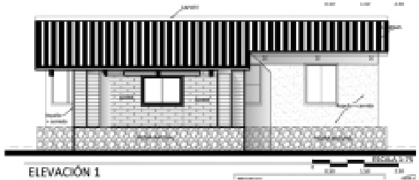
Figura 32. San Marcos, Muros de tarimas de estivamiento recicladas y tratadas con integración de muros de adobe y piedra
